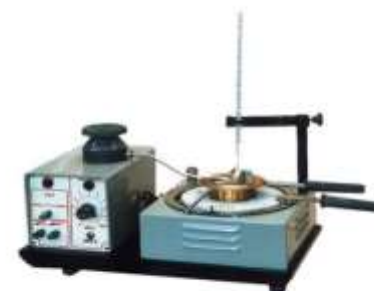
Прилад для визначення температури спалаху
