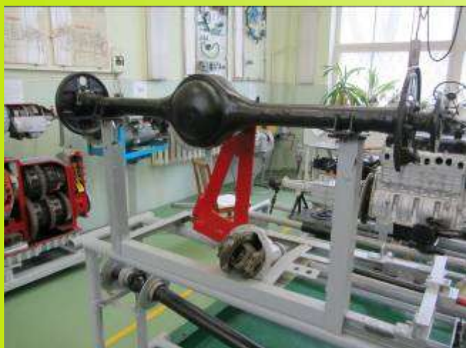
Стенд для визначення параметрів робочого процесу головної передачі
