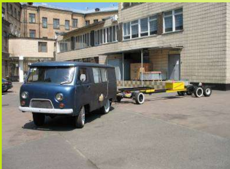
Експериментальний модульний автопоїзд для дослідження маневреності
