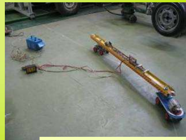
Самохідна модель довгобазного автопоїзда з керованим напівпричепом
