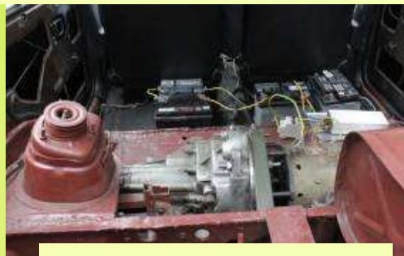
Електрична складова гібридної енергоустановки
