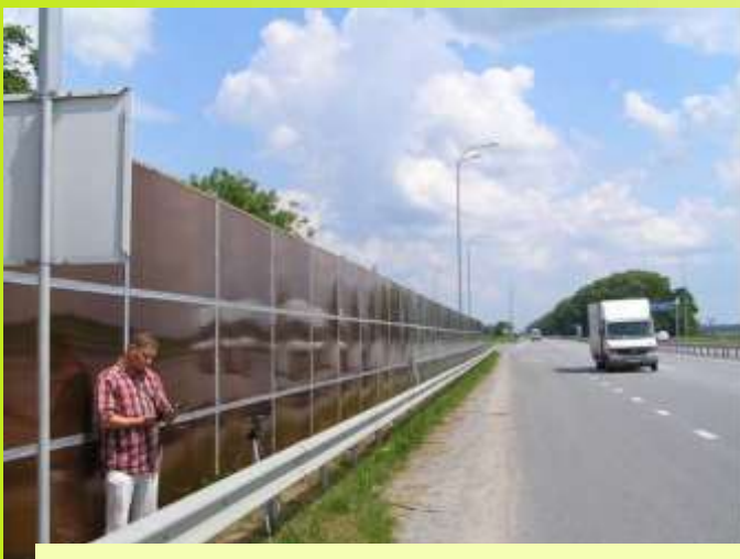
Вимірювання шумового навантаження від транспортного потоку
