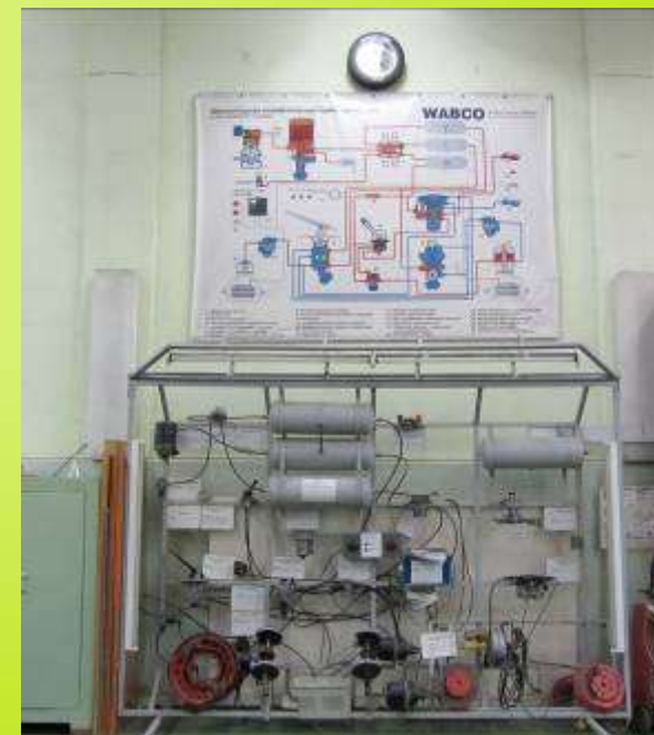
Стенд для досліджень роботи гальмівної системи з пневматичним приводом та ABS
