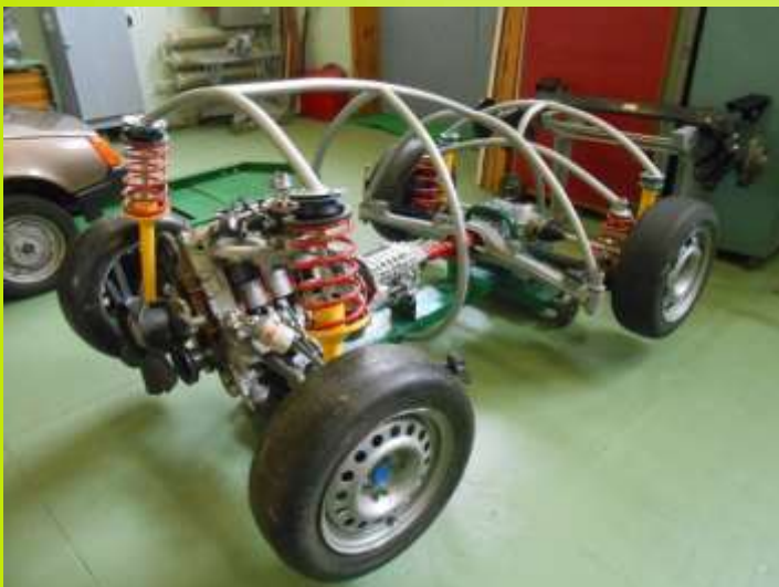
Демонстраційний стенд «Шасі легкового автомобіля»
