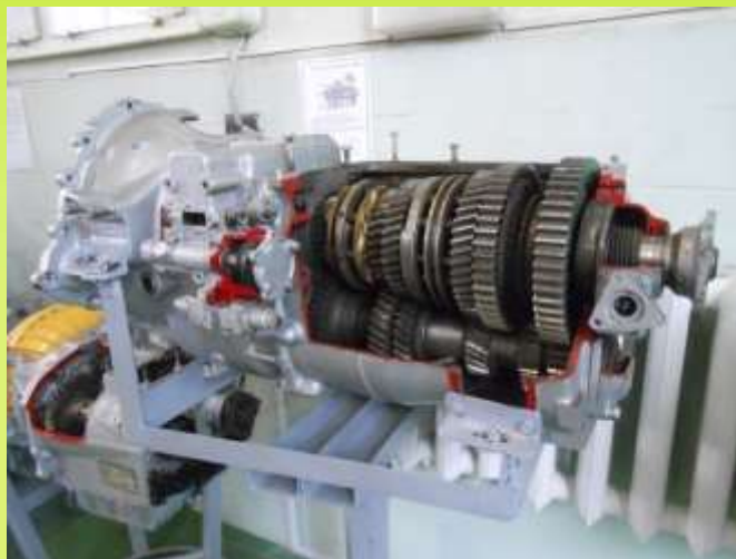
Демонстраційні стенди для вивчення конструкцій коробок передач
