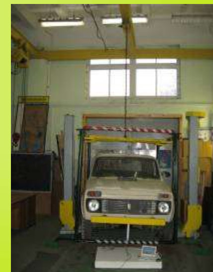
Визначення моменту інерції легкового автомобіля
