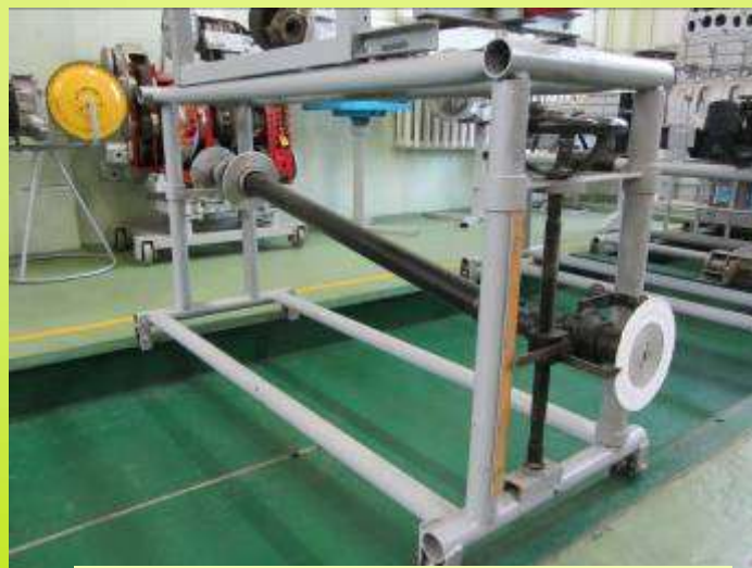
Стенд для визначення параметрів робочого процесу карданної передачі
