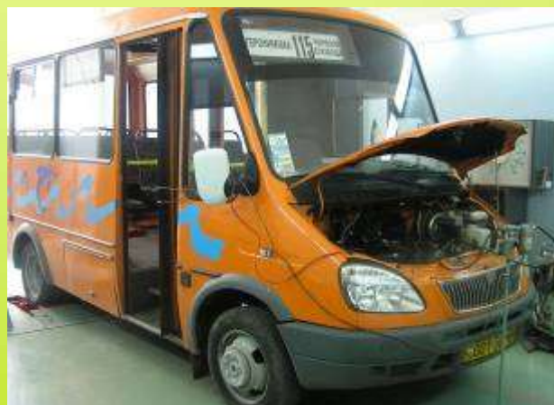
Стендові випробування газобалонного автомобіля
