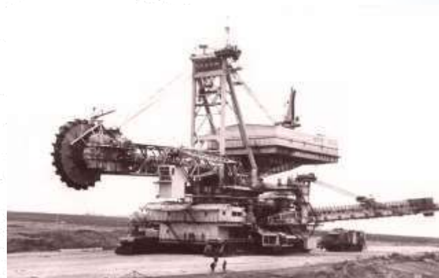
Екскаватор роторний крокуюче-рейковий добувний ЕРШРД-5250
