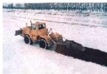
Екскаватори траншейні роторні ЕТР -137 та ЕТР-140
