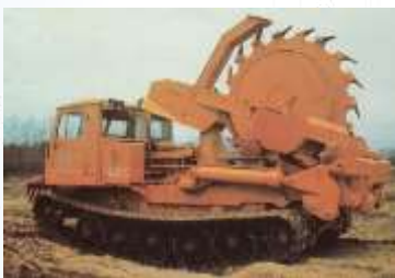
Екскаватори траншейні роторні ЕТР -137 та ЕТР-140
