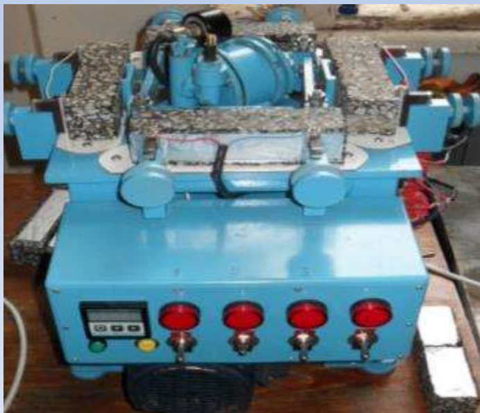
Прилад для випробування монолітних дорожньо-будівельних матеріалів на втому
